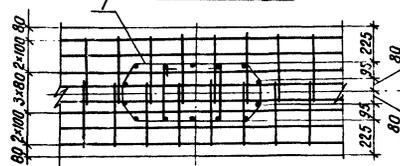
*Одновременно с установкой арматурных и закладных изделий, учтенных в спецификации, в опалубку у каждой фундаментной балки устанавливаются арматурные спирали Сп 1 и Сп 2, обеспечивающие надежную анкеровку арматурных выпусков из свай в монолитном бетоне балок (см. д. в. 35, 36)*
