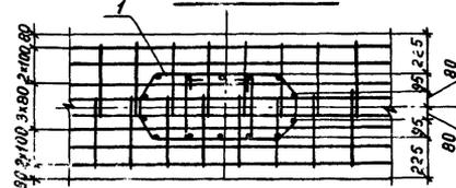
Одновременно с установкой арматурных и закладных изделий, учтенных в спецификации в опалубку у каждой фундаментной балки устанавливаются арматурные спирали СП1 и СП2, обеспечивающие надежную анкеровку арматурных выпусков из свай в монолитном бетоне балок (см. д.д. 35, 36)
